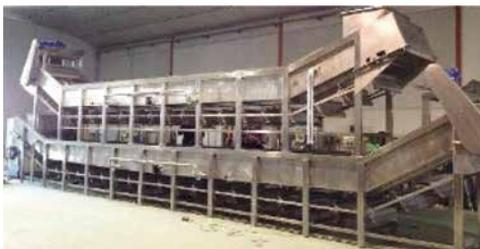
Machine de pré cuisson et cuiseur blancheur d'artichauts
